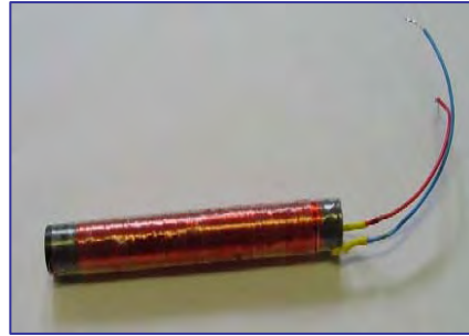
T. Sterken et al., 2005 IMEC, K.U. Leuven 300 \mu\text{W} , 50 g @ 5 Hz, 5 \text{cm}^3
