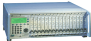
Centrale de mesure
